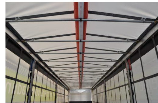
RSAB wird mittig montiert
