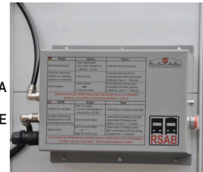
Steuereinheit mit Versorgungsanschlüssen und aufgedruckter Bedienungsanleitung
